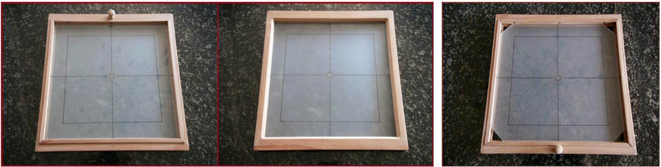
*Note : On m'a suggéré de couper les coins du verre dépoli pour améliorer la circulation de l'air à l'intérieur de l'appareil lorsque le dos est déplacé. Cela pourrait être utile, surtout pour les formats assez grands. Un avantage supplémentaire est que cela permet, en regardant par ces coins, de vérifier facilement s'il y a des obstacles (soufflet affaissé...) entre l'objectif et la plaque humide.*
