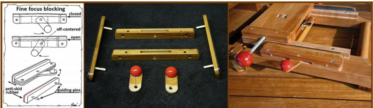
Voici le système de blocage du chariot de mise au point fine. La poignée est excentrée et est garnie à l'intérieur d'une couche de caoutchouc antidérapante. Le plateau est pourvu de deux de ces poignées.
