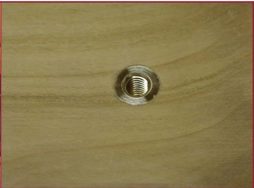
L'embase fileté est usinée dans une tige de laiton de 16 mm. Au bas de la page précédente, on voit les différentes étapes : perçage du point central et du trou, réalisation du filetage, ébavurage, finition du filetage, perçage d'un trou de 16 mm dans la traverse, enfoncement et collage de l'embase terminée.
