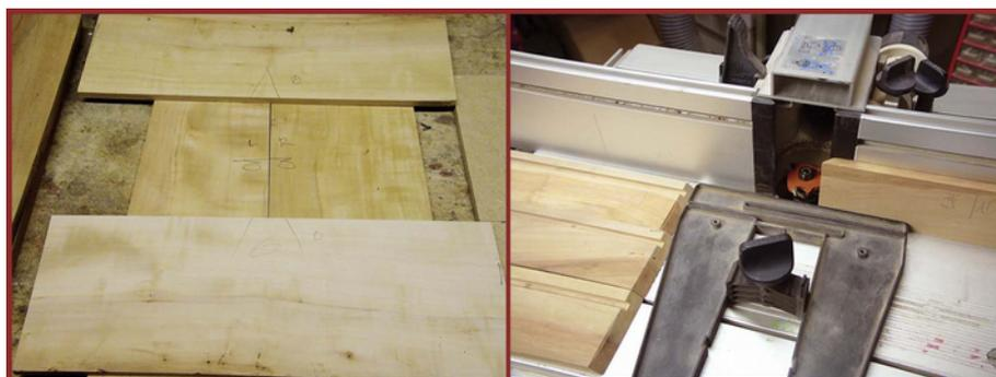
Ensuite, voyez comment ces pièces sont collées sur un panneau MDF épais de 6mm, le même que celui utilisé dans l'autre corps. Ce panneau s'insère dans une rainure du corps avant.
