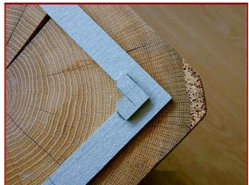
Les images de droite montrent le loquet permettant de fixer l'insert dans le porte-plaque. Pour finir une si petite pièce, j'utilise une si petite pièce, j'utilise du ruban adhésif double face pour la fixer, une lime à ongles et de la laine d'acier. Les inserts de différentes tailles peuvent
