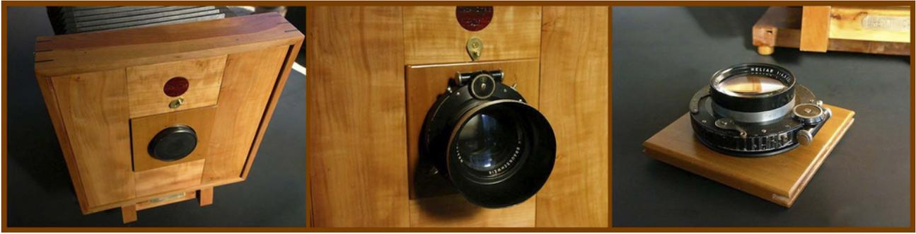
La platine porte-objectif a deux rainures ; la rainure supérieure est suffisamment profonde pour dégager la rainure inférieure lorsque l'on soulève la platine porte-objectif, après avoir enlevé le dispositif de blocage en laiton. La platine peut alors être retirée, ou retournée et verrouillée en place, l'objectif restant en sécurité à l'intérieur de la caméra pendant le transport.
