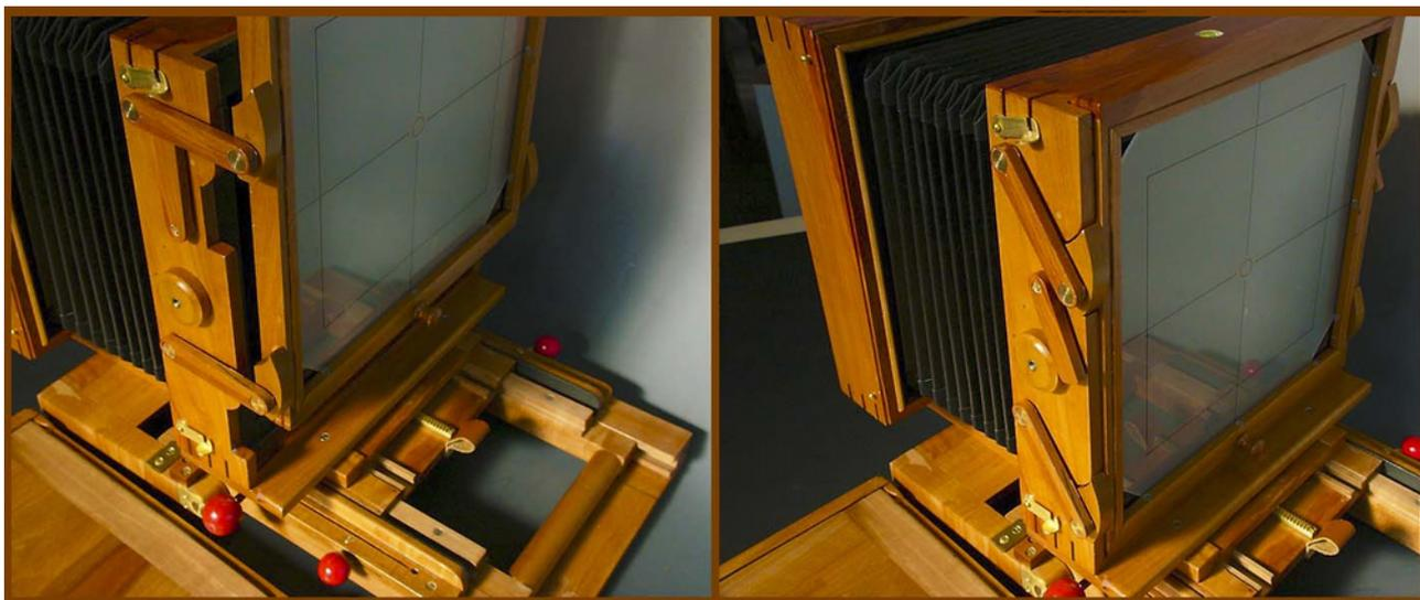
Ensuite, une vue plus rapprochée du porte-plaque : le bouton en bois que j'avais initialement imaginé a dû être remplacé par une bande de cuir, car l'espace entre le cadre et l'appareil photo était trop petit.
