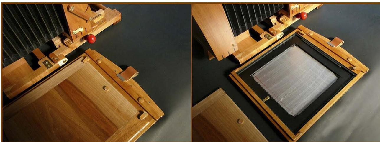
Le volet du porte-plaque est une feuille d'acier galvanisé de 1mm. Je l'ai peint en noir mais la peinture n'a pas résisté aux frottements des mouvements d'entrée et de sortie. J'ai fini par la poncer. Je sais qu'il existe des procédés de noircissement à froid et à chaud (noircissement chimique / oxydation noire), mais j'en sais trop peu pour les entreprendre ceci.
