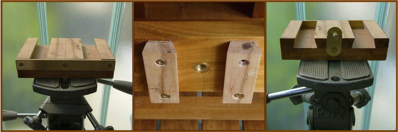
*Et enfin, une plaque de dégagement rapide a été fabriquée. Elle se visse rapidement sur le trépied pour positionner correctement et en toute sécurité la chambre. Pour cela, il suffit d'emboîter les pièces en queue d'aronde du plateau dans la plaque du trépied, et de bloquer l'ensemble avec le boulon en laiton.*
