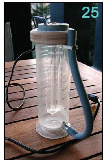
De menger wordt geplaatst op een maatbeker waaraan onderaan een aftapdarm bevestigd is, hiermee tapt men de vloeistof af op het laagste punt en blijven de luchtballen (als die er zijn) boven (zie foto 25).
