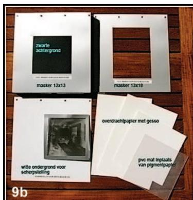
Naargelang het formaat, wordt het grote negatief in het gepaste masker geplaatst waarmee het in contact kan worden belicht op het pigmentpapier. De maskers heb ik gesneden uit aluminium platen van 0,2 mm welke men kan bekomen bij de drukker.
