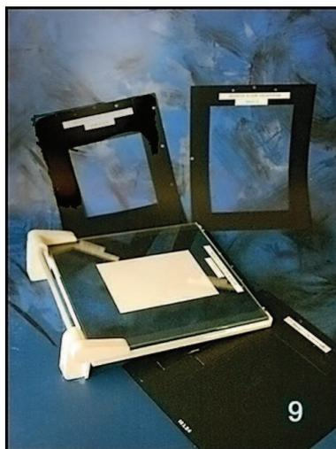
Het tweede wat eenvoudiger drukraam bestaat uit een grondplank waarop vier registerpennen zijn gelijmd.
