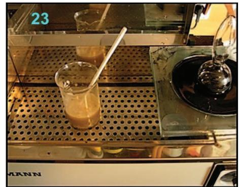
De gelatine, de suiker, de arabische gom en de Agepon worden in het koude water gegoten en gedurende 30 min. af en toe geroerd, daarna wordt de vloeistof au bain-marie opgewarmd en wordt de gelatine vloeibaar (zie foto 23).
