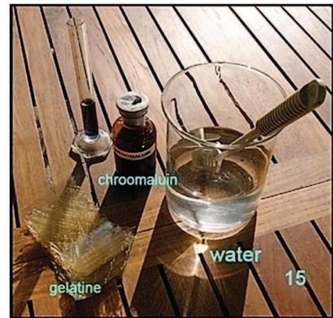
De gelatine wordt in koud water geweekt gedurende 30 min. daarna wordt het au bain-marie verwarmd tot de gelatine volledig gesmolten is. Ter zelfde tijd wordt de chroomaluinoplossing eveneens opgewarmd en daarna geroerd door de warme gelatine.
