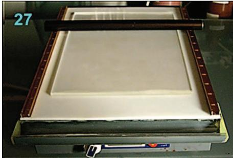
Om het pigment gemakkelijk op het papier te gieten, bouwde ik een hulpstuk, bestaande uit een plexi plaat met daarop langs weerszijden een aluminium profiel dat de dikte van de te gieten laag bepaald. In het midden ligt een wegneembare plexi plaat waarop het papier gelegd wordt (zie foto 27).
