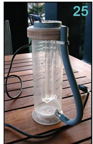
Le mélangeur est placé sur une éprouvette, au fond de laquelle a été attaché un tuyau qui permet de prélever le liquide par le bas et éviter ainsi les bulles d'air éventuelles qui surnagent près de la surface (voir photo 25).
