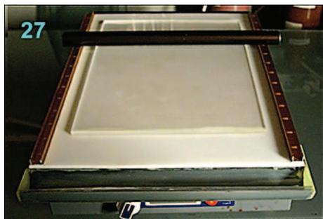
Pour faciliter l'étendage du pigment sur le papier, j'ai construit un accessoire composé d'une plaque en plexi pourvue sur ses côtés de profils en aluminium qui détermineront l'épaisseur de la couche pigmentaire. Au milieu de ce dispositif il y a un plaque amovible en plexi sur laquelle on pose le papier (voir photo 27).
