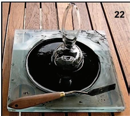
Au départ, le pigment surnage sur le liquide, mais après un certain temps (environ 20 min.), on obtient une pâte homogène
