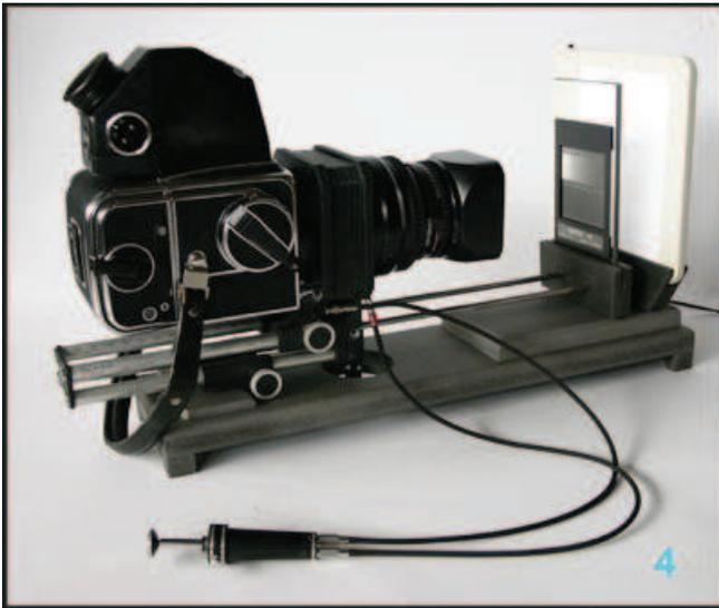
Sous le soufflet et mon appareil, j'ai installé une glissière que j'ai construite, et qui me permet de monter le soufflet et le porte-négatif de manière à rester exempts de toute vibration.
