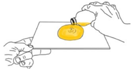
2. Versez le collodion au milieu de la plaque
